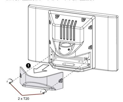
1. 松开接线盒盖板的 2 个螺钉,取下接线盒盖板。
