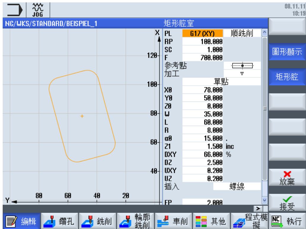
圖像 7-3 包含 G 碼程式單節圖形檢視之參數畫面
