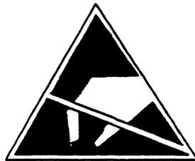
**EGBs** können durch Spannungen und Energien zerstört werden, die weit unterhalb der Wahrnehmungsgrenze des Menschen liegen. Solche Spannungen treten bereits dann auf, wenn ein Bauelement oder eine Baugruppe von einem nicht elektrostatisch entladenen Menschen berührt wird. Bauelemente, die solchen Überspannungen ausgesetzt wurden, können in den meisten Fällen nicht sofort als fehlerhaft erkannt werden, da sich erst nach längerer Betriebszeit ein Fehlverhalten einstellen kann.
