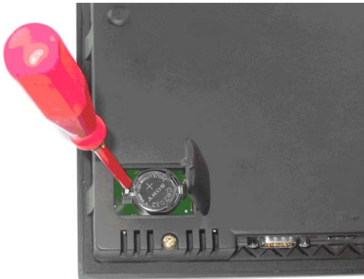
Figure 11-21 Remplacement de la pile de sauvegarde du pupitre opérateur du variateur en armoire
