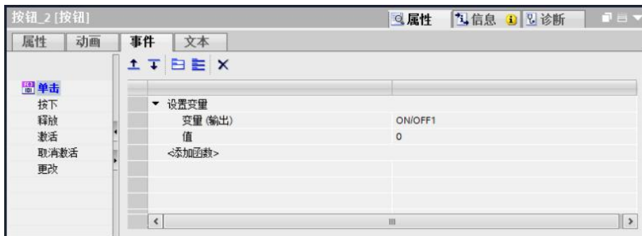
图 2-6 停止信号对应的 I/O 域常规设置
