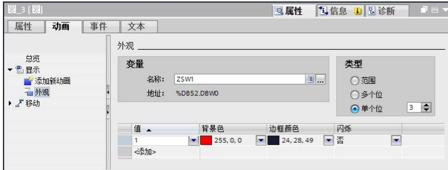
图 2-15 故障信号对应的 I/O 域常规设置
