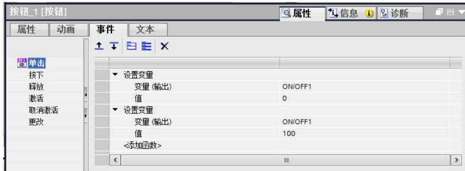
图 2-5 启动信号对应的 I/O 域常规设置
