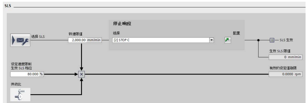
图 4-105 示例：自动生效的 SLS
