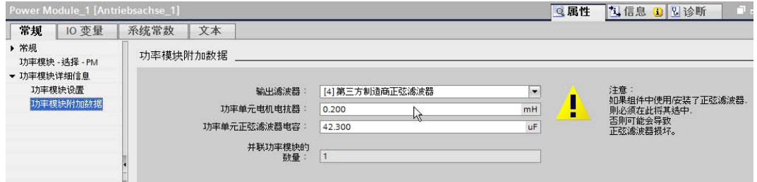
图 4-25 示例：功率模块附加数据
