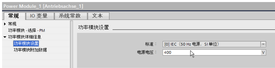
图 4-24 示例：功率模块设置
