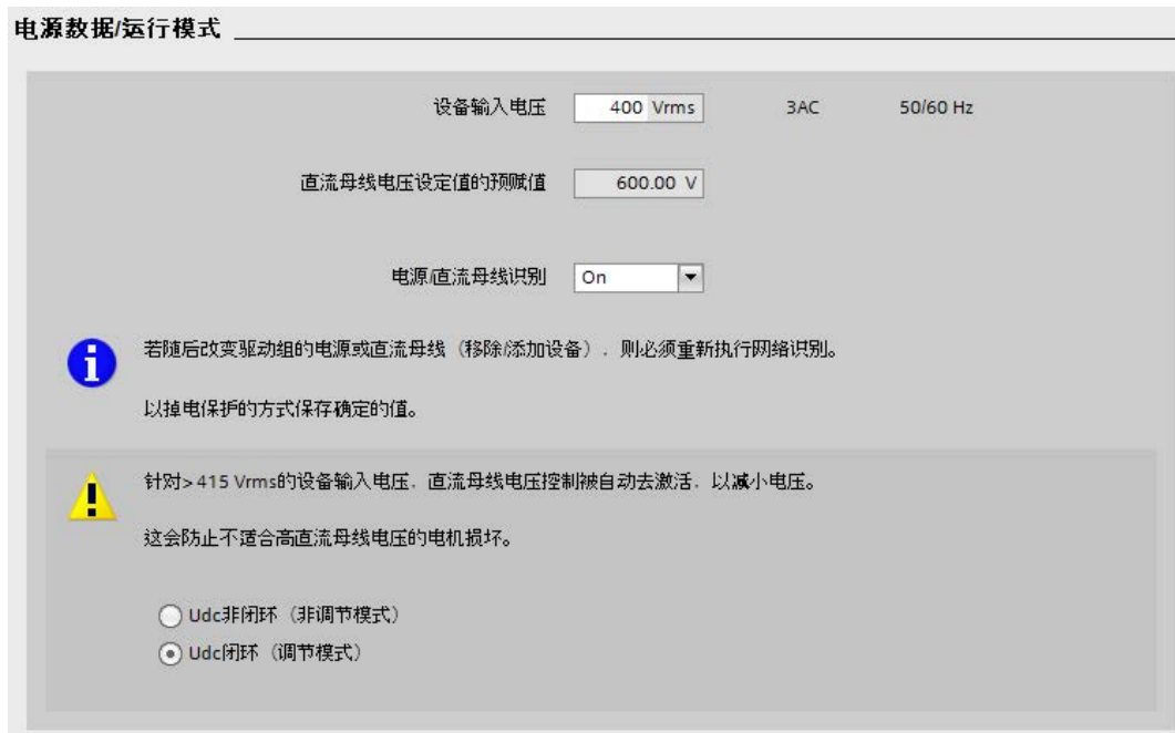
图 4-72 示例：调节型电源模块上的电源数据/运行方式
