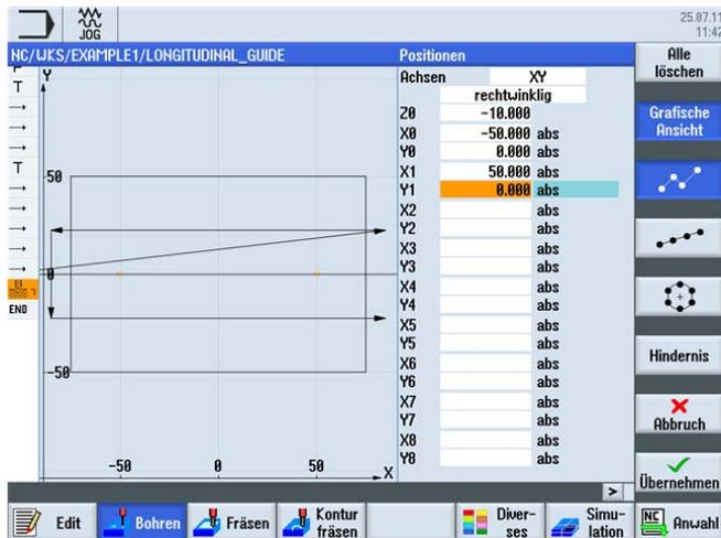
Bild 6-22 Positionen - Einzelbohrungen
