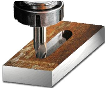
Der Langlochfräser (auch Bohrnutenfräser genannt) schneidet über die Mitte und kann deshalb ins Volle eintauchen. Er hat meist zwei oder drei Schneiden.
