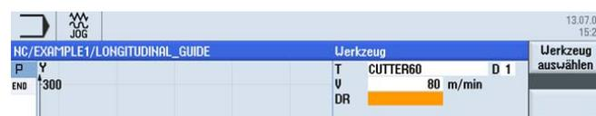
Bild 6-12 Werkzeug - Schnittgeschwindigkeit
