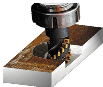
Der Wendelschaftfräser ist ein vielschneidiges Werkzeug, welches durch die wendelförmige Anordnung der Schneiden eine besonders "ruhige" Bearbeitung ergibt.
