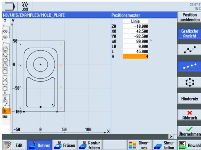
Bild 8-37 Bohrrreihe eingeben
