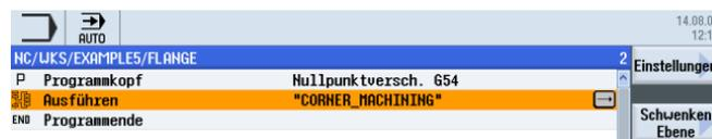
Bild 10-21 Unterprogramm in Hauptprogramm eingefügt
