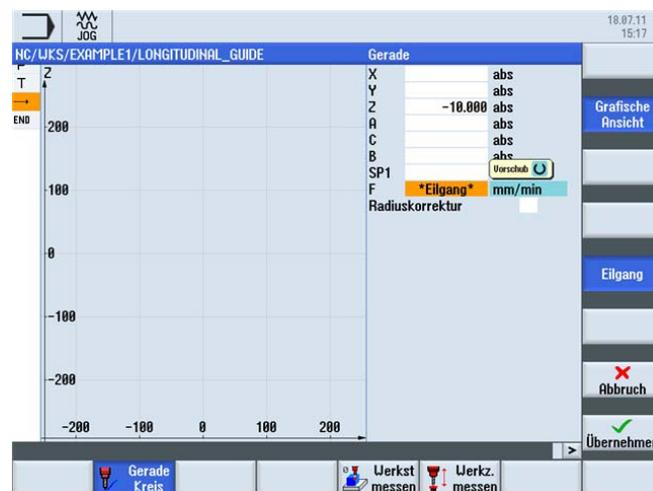
Bild 6-14 Verfahrenweg eingeben - Werkzeug in Z positioniert
