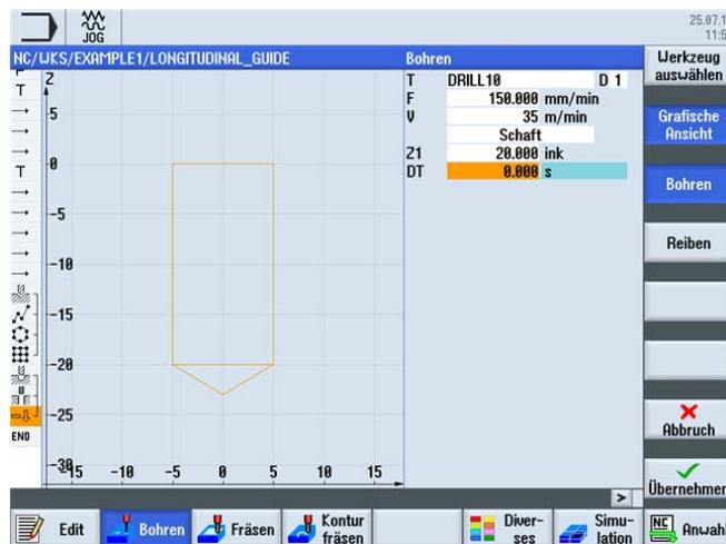
Bild 6-29 10er Bohrungen
