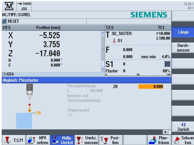
Bild 5-5 Ableich Taster Länge
