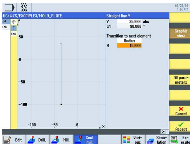
Figura 8-5 Introducción de un contorno con trayecto vertical
