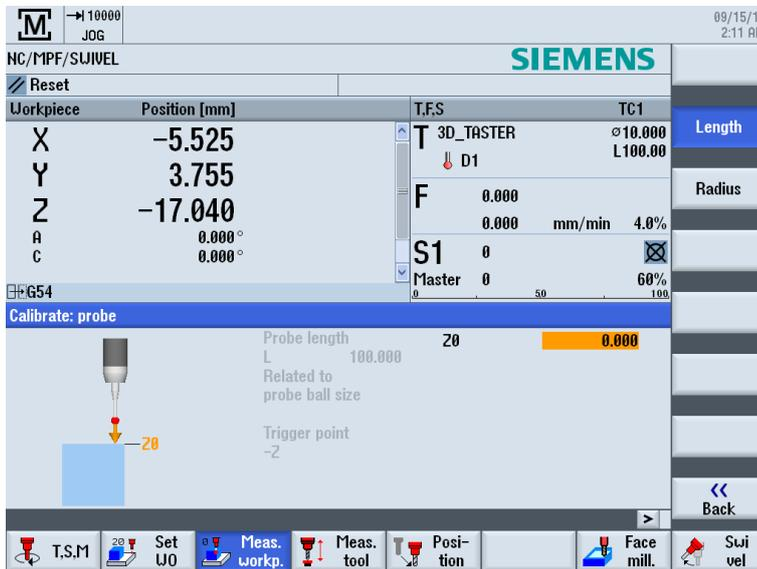
Figura 5-5 Calibrar palpador, longitud
