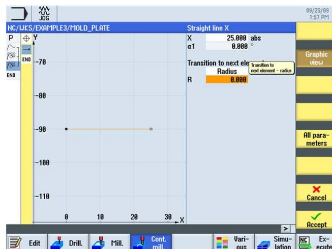
Figura 8-15 Introducción de un contorno con trayecto horizontal
