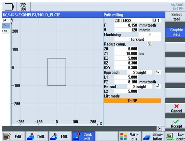
Figura 8-8 Desbaste de un contorno
