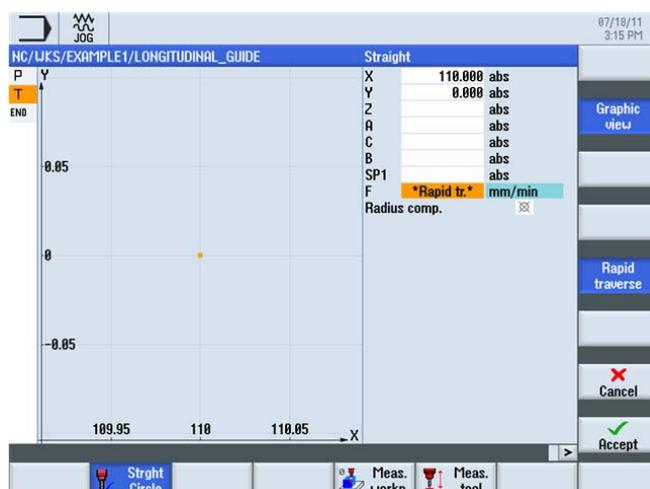
Figura 6-13 Introducción del trayecto, corrección del radio
