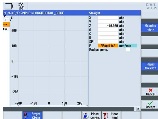
Figura 6-14 Introducción del trayecto, herramienta posicionada en Z
