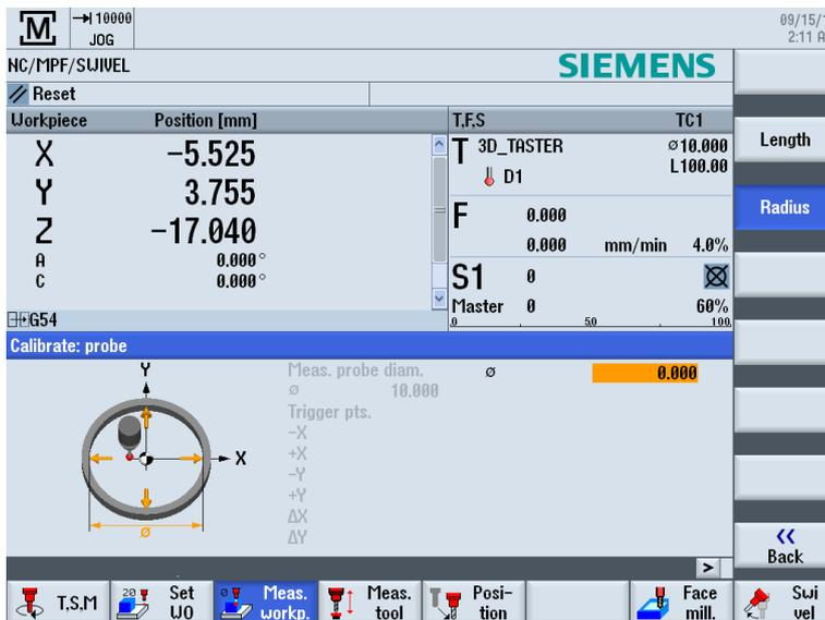
Figura 5-6 Calibrar palpador, radio
