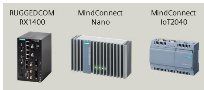
Abbildung 4: Hardware für die OPC UA-Kommunikation mit der MindSphere
