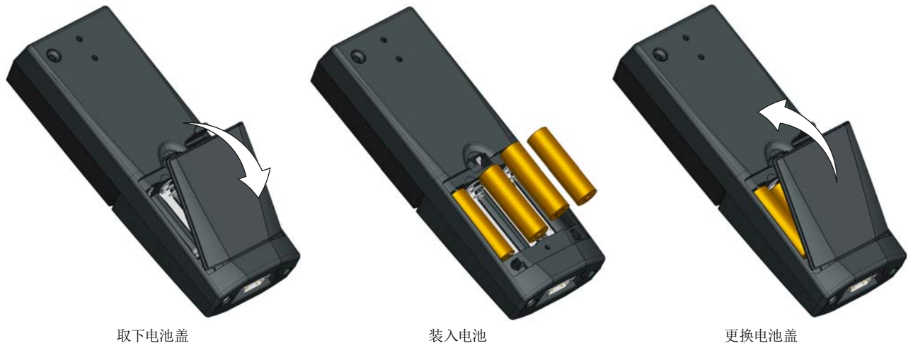
图 7-4 安装手持套件的电池
