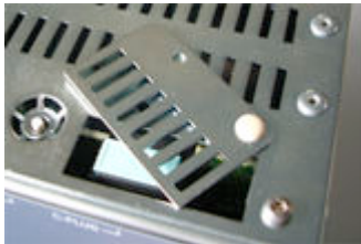
Figura 4-19 C-PLUG del X-300EEC
