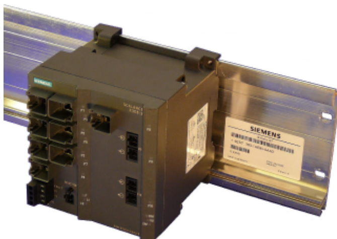
Figura 5-2 Montaje de un IE Switch X-300 en un riel de perfil SIMATIC S7-300
