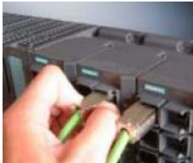
Bild A-3 Entriegelung des RJ45 Plug (am Beispiel des IE FC RJ45 Plug 180)
