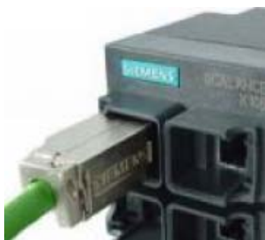
Bild A-2 Stecken des IE FC RJ45 Plug (am Beispiel des IE FC RJ45 Plug 180)
