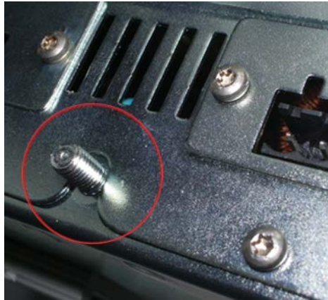
图 6-1 位于 X-300EEC 机壳底部的接地螺栓
