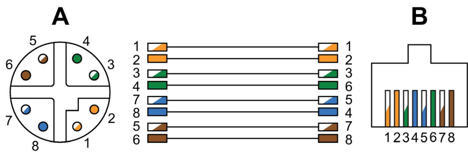
A X 编码 M12 连接器的正视图，符合 IEC61076-2-109 B RJ-45 连接器的正视图、俯视图，具有引脚分配，符合 EIA/TIA 568B
