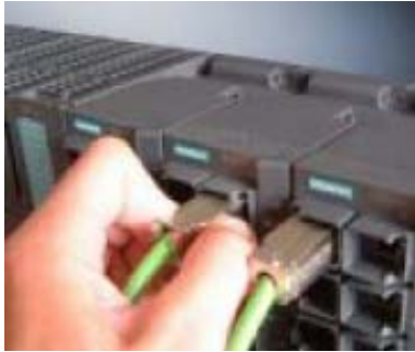
图 A-3 松开 RJ-45 插头（以 IE FC RJ-45 Plug 180 为例）
