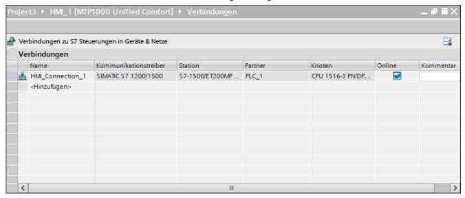
Jede Tabellenzeile repräsentiert eine Verbindung zu einer Steuerung mit ihren jeweiligen Eigenschaften. Wenn Sie eine Verbindung in "Geräte & Netze" anlegen, handelt es sich um eine integrierte Verbindung. Die Kommunikationsparameter werden automatisch richtig befüllt.
