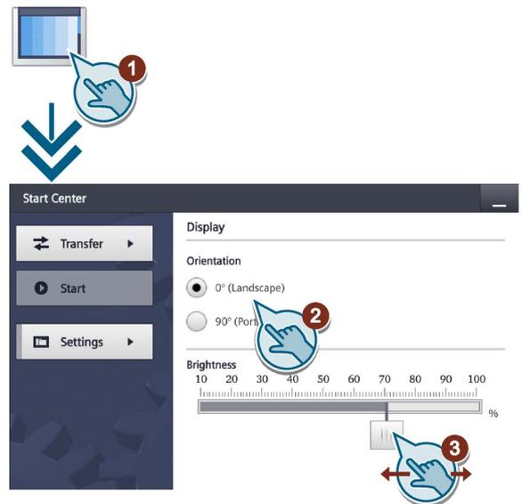
Mit der Systemfunktion "SetzeHelligkeit" können Sie die Display-Helligkeit des Bediengeräts auf einen Wert zwischen 0% und 100% einstellen. Wenn die Helligkeit auf 0% gesetzt wird und der Bildschirmschoner sich einschaltet, wird durch eine Berührung des Display oder einer Taste der Bildschirmschoner ausgeschaltet. Die Helligkeit wechselt dann zu dem Wert zurück, der vor Aufruf der Systemfunktion eingestellt war.
