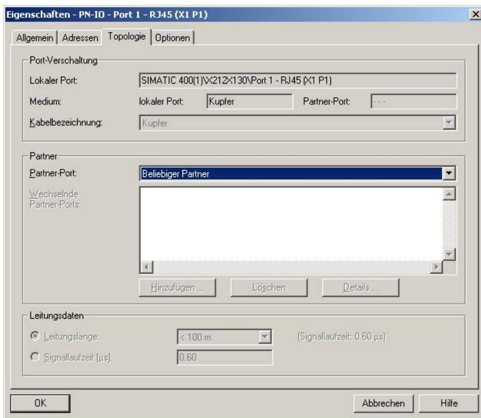
图 7-1 STEP 7 HW Config 对话框，“Topology”（拓扑）选项卡
