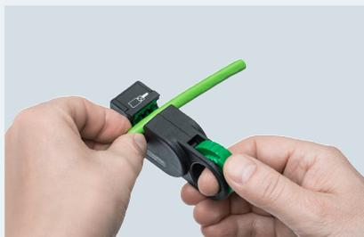
*Leitungsende mit dem FastConnect Stripping Tool absetzen*
