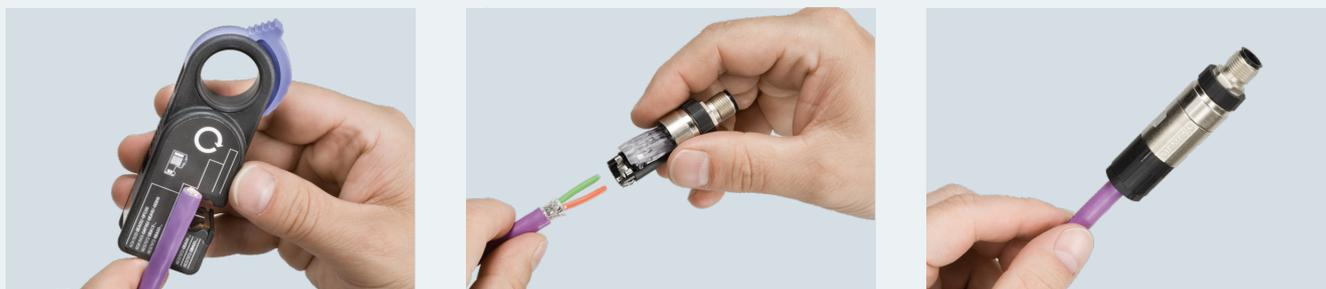
Abisolieren und Montage mit M12-Steckverbinder
