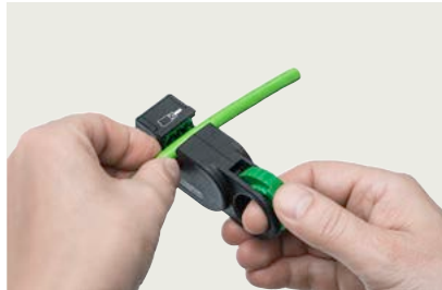
Leitungsende mit dem FastConnect Stripping Tool absetzen
