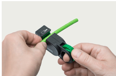
Leitungsende mit dem FastConnect Stripping Tool absetzen
