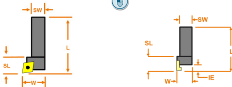
图 9-16 以车刀和切断刀为例，刀杆的参数
