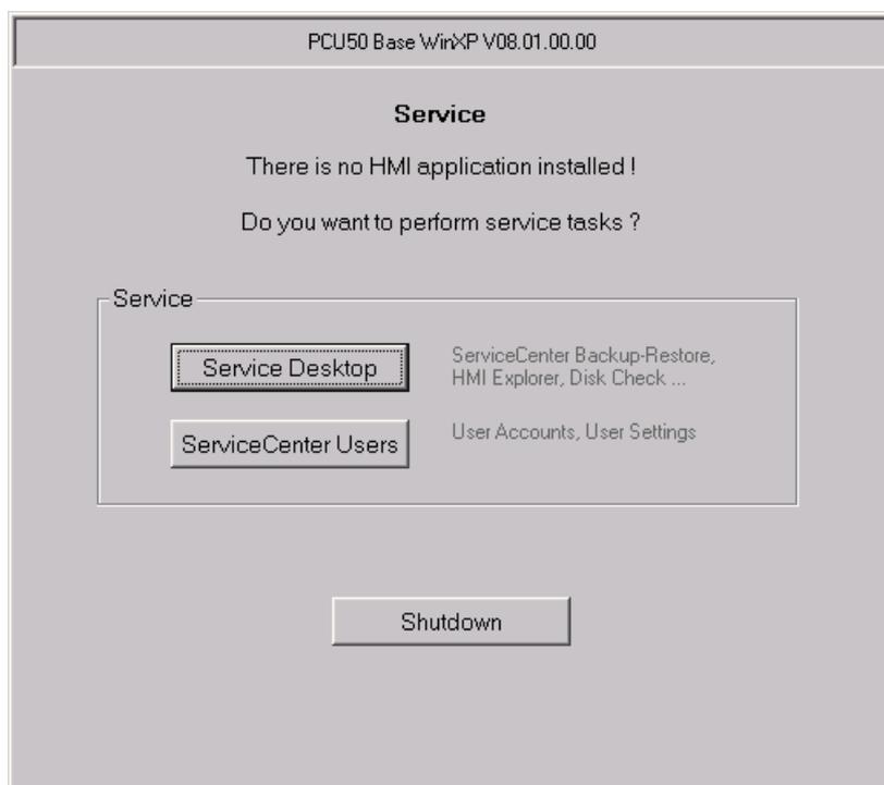
图 1-5 不带 HMI 程序的维修启动对话框
