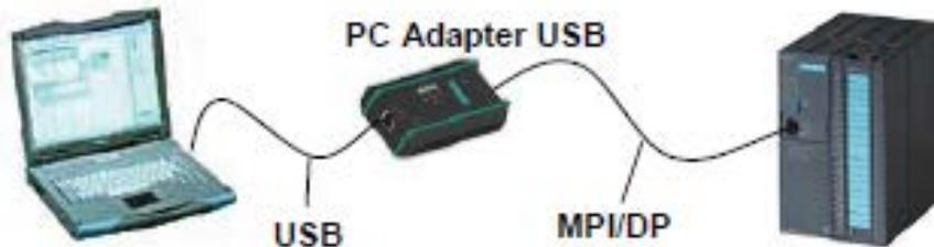
Bild 1-1 Konfiguration mit PC Adapter USB A2
