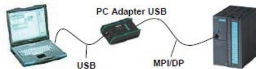
Bild 1-1 Konfiguration mit PC Adapter USB A2
