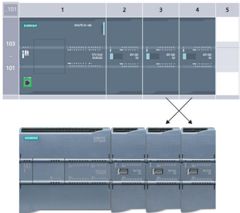
图 3-4 实际安装时模块位置颠倒
