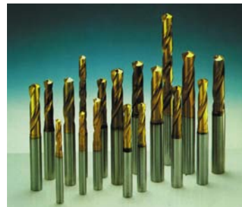
Titan-Nitrid (TiN)-beschichtete Bohr- und Fräswerkzeuge
