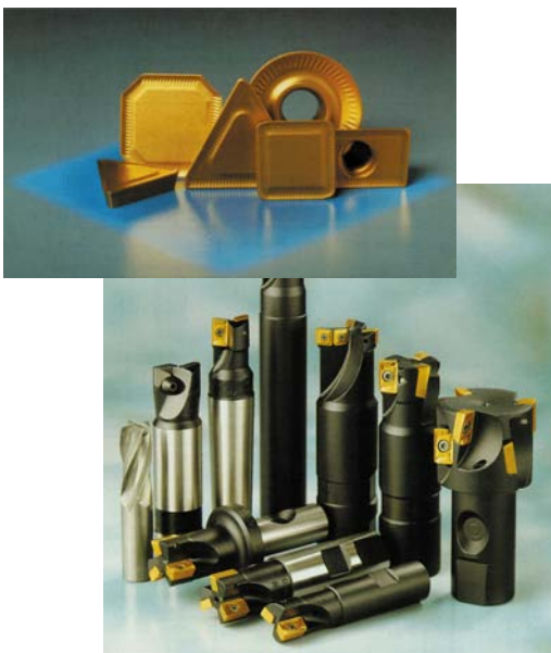
Werkzeuge mit gesinterten Schneidplatten
