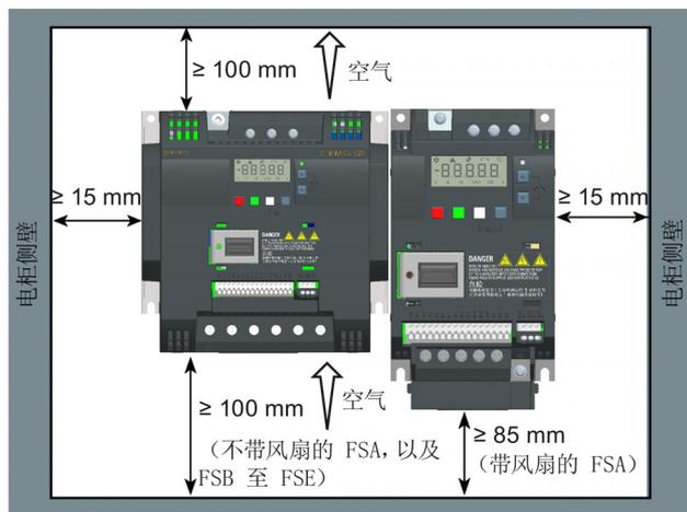
变频器必须垂直安装在封闭电气操作区域或控制柜内非易燃的平坦表面上。
