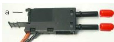
Simplex 接头 6GK1901-0FB00-0AA0 （方形外壳为插头适配器，可拆卸， 单独订货 6ES7195-1BE00-0XA0）
