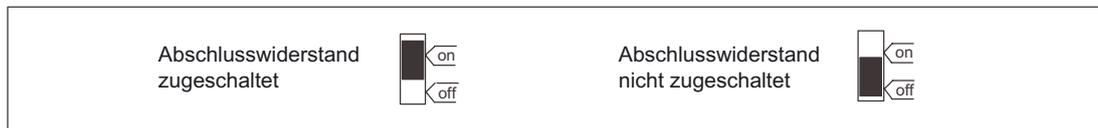
Bild 5-2 Abschlusswiderstand zugeschaltet und nicht zugeschaltet
