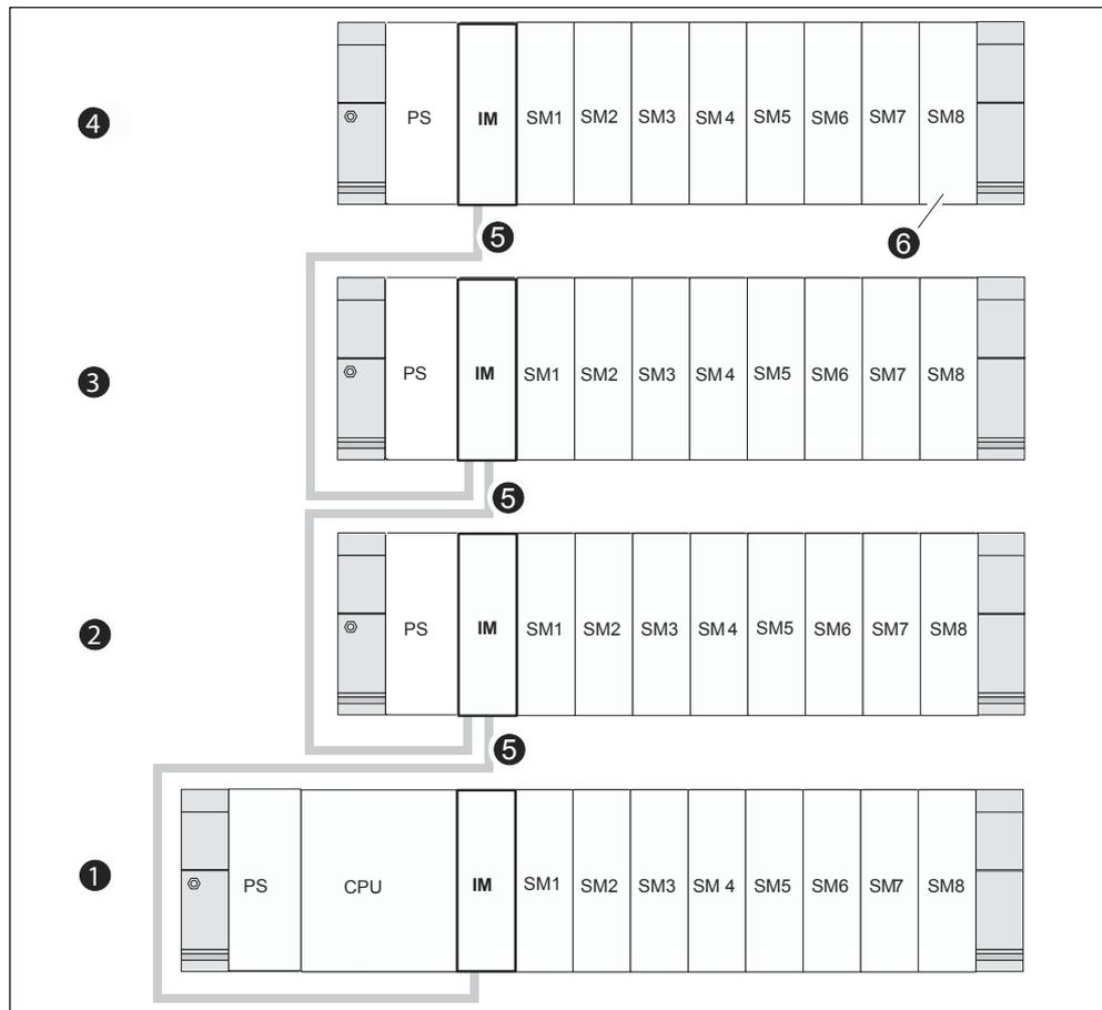
Bild 5-5 Maximalausbau über vier Baugruppenträger
