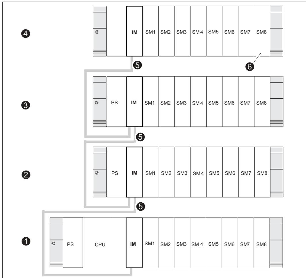
Figura 5-5 Configurazione massima con quattro telai di montaggio
