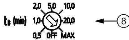
Bild 2-12 Drehkodierschalter Pufferzeit
