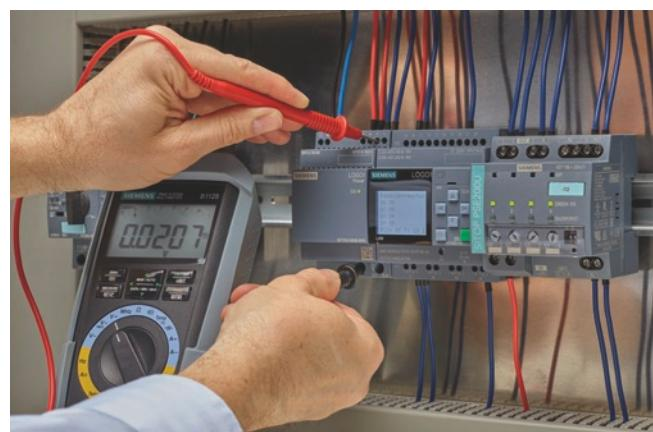
Der Strommonitor der LOGO!Power 24 V/2,5 A gibt bei Nennstrom eine Spannung von 50 mV aus. Bei der abgebildeten Messung werden z. B. 20,7 mV gemessen, die 1,035 Ampere Ausgangsstrom entsprechen:  $20,7 \text{ mV} / 50 \text{ mV} \times 2,5 \text{ A}$ .
