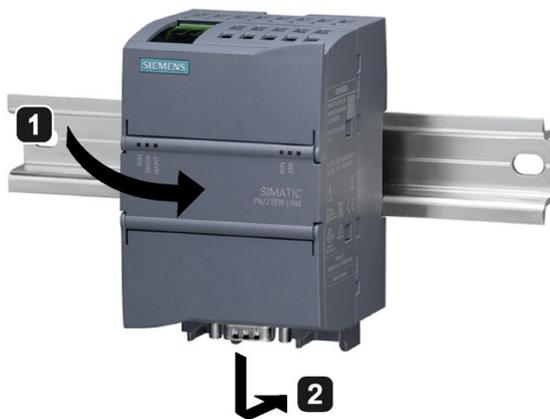
Bild 6-1 PN/J1939 LINK Hutschienenmontage
