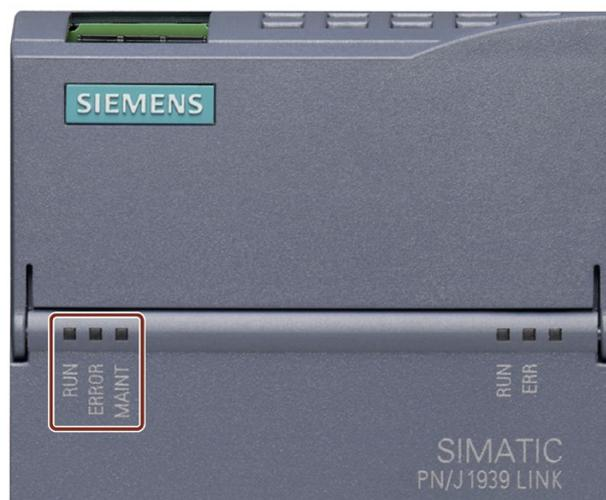
Bild 10-1 Status-LEDs - Betriebszustand des PN/J1939 LINK / PROFINET-Diagnose
