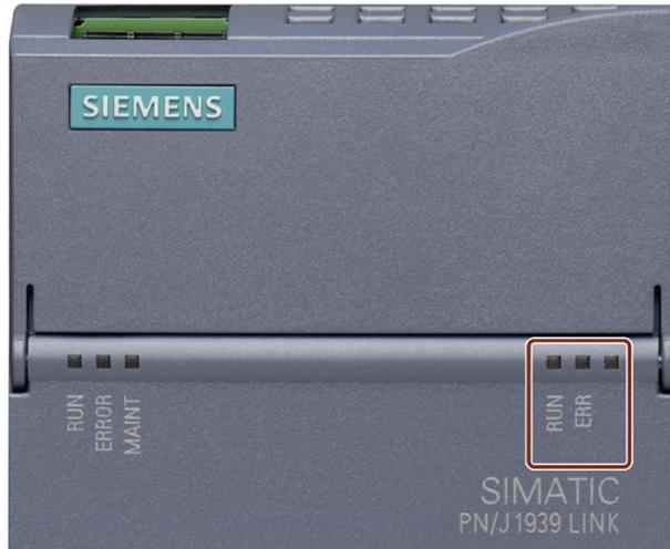
Bild 10-3 Status-LEDs PN/J1939 LINK
