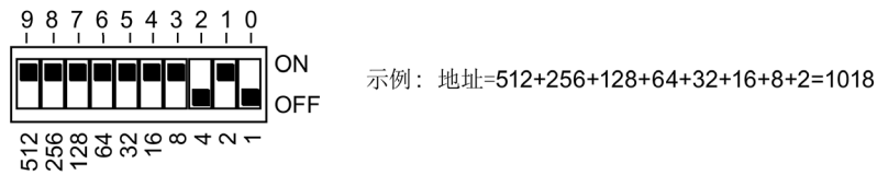
图 3-1 设置地址开关（DIP 开关）的示例
