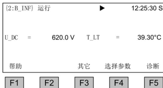
图 4-10 操作屏幕 - 示例：通过基本整流柜馈电
