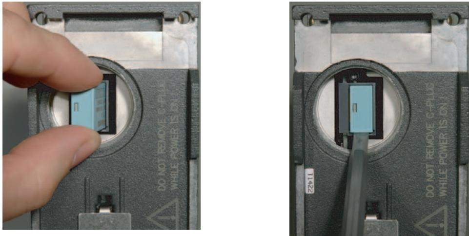
Bild 2-7 C-PLUG in das Gerät einsetzen und C-PLUG mit Hilfe eines Schraubendrehers aus dem Gerät entnehmen
