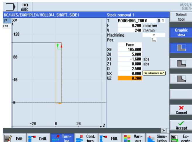
Figure 9-5 Surfaçage de la pièce
