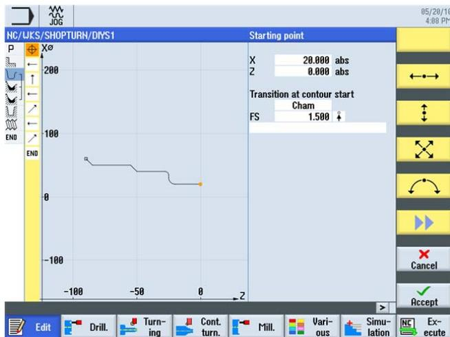
Figure 12-3 Contour dans le calculateur de contours
