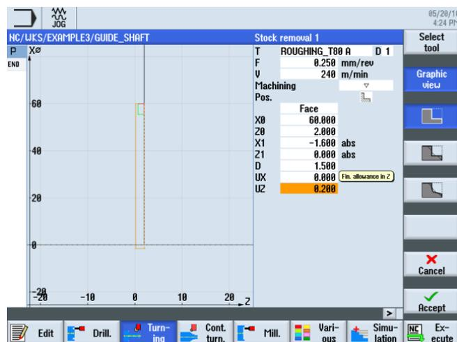
Figure 8-3 Surfaçage de la pièce
