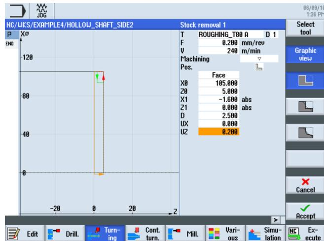
Figure 9-46 Surfaçage de la pièce
