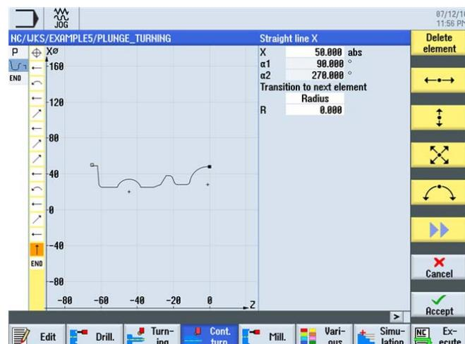
Figure 10-4 Contour dans le calculateur de contours
