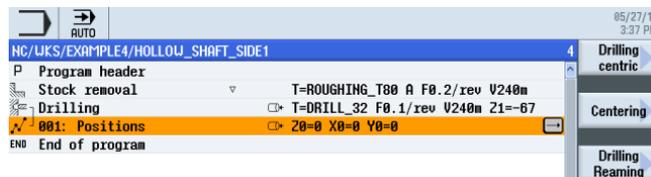
Figure 9-10 Gamme d'usinage après saisie de la position de perçage
