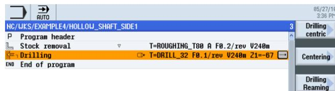
Figure 9-8 Gamme d'usinage après perçage
