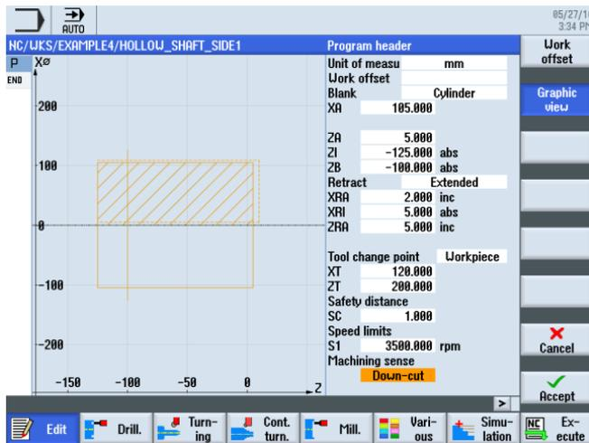
Figure 9-4 Dimensions de la pièce dans l'en-tête du programme
