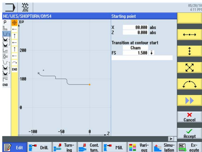
Изображение 12-15 Наружный контур в контурном вычислителе
