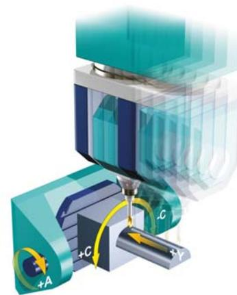
Für einen Umlauf schwenkt der Tisch  $90^\circ$  um die A-Achse. Die C-Achse dreht jeweils um von  $+90^\circ$  auf  $-90^\circ$  und das Werkzeug verfährt in der Y-Achse.
