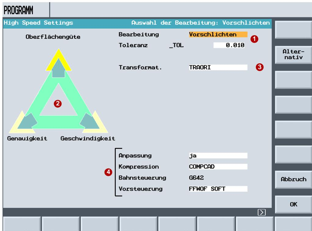
Entsprechend der Parameter-Wahl ① zeigen die gelben Pfeile ② entweder in Richtung "Geschwindigkeit", "Oberflächengüte" oder in Richtung "Genauigkeit".
