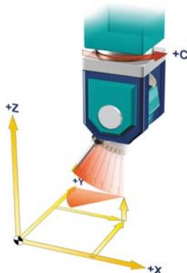
Mit zwei Drehachsen, z. B. B und C wird die Anstellung des Werkzeugs, d. h. die Werkzeugorientierung verändert.
