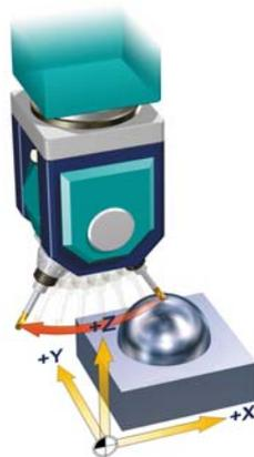
im NC-Programm wird eine Orientierungsänderung der B-Achse ohne Verfahrbewegung der Werkzeugspitze programmiert. Die Steuerung dreht einfach die Achse, die Werkzeugspitze bleibt **nicht ortsfest**.
