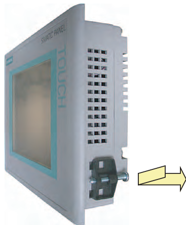
Beispiel: Kunststoff-Spannklemme am TP 177A einsetzen
