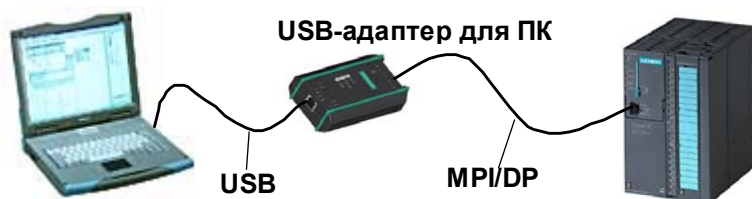
Рис.1-1: Конфигурация с использованием USB-адаптера для ПК
