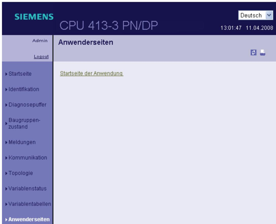
Dazu erstellen Sie die Anwenderseite in einem beliebigen Web-Editor, unter Verwendung der Symbole aus dem STEP 7-Anwenderprogramm. Das zu STEP7 mitgelieferte Programm Web2PLC wandelt die erstellte Anwenderseite dann in DBs um. Jede Anwenderseite darf maximal 1 MB groß sein. Die erzeugten DBs werden in die CPU geladen und der Link auf die Anwenderseite wird angezeigt. Durch einen Klick auf den Link wird die Anwenderseite in einem neuen Fenster gestartet.
