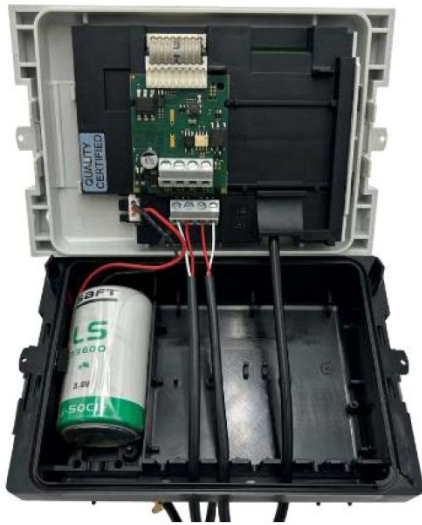
图 2-7 MODBUS 通信模块安装在槽 1 位置
