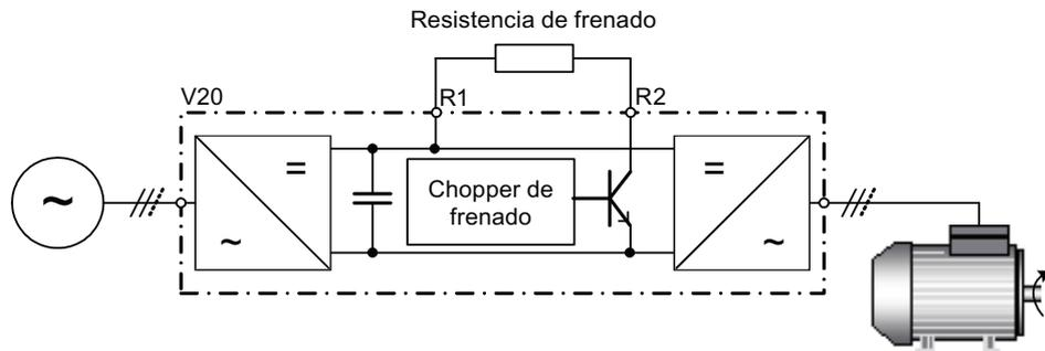
La potencia continua  $P_{DB}$  y el ciclo de carga de la resistencia de frenado se pueden modificar usando el módulo de frenado dinámico (para los tamaños de bastidor A/B/C) o el parámetro P1237 (para el tamaño de bastidor D).
