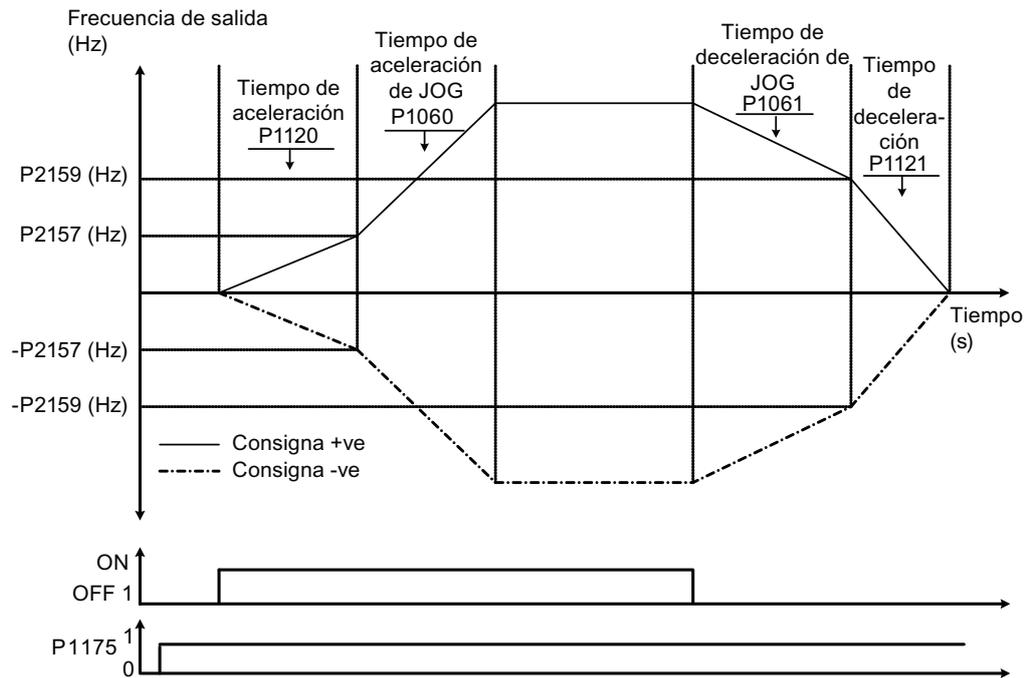
Tenga en cuenta que el algoritmo de doble rampa utiliza los bits 1 y 2 de r2198 para determinar  $f_{real} > P2157$  y  $f_{real} < P2159$ .
