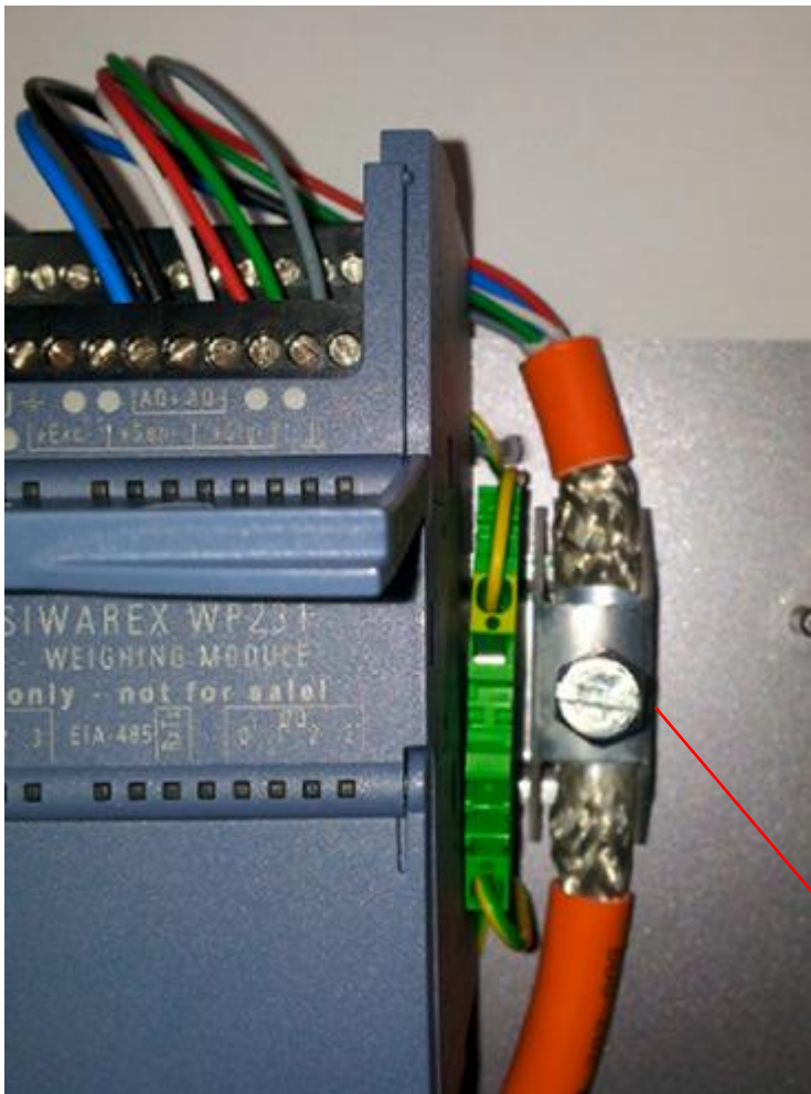
图 2-2 称重传感器接线及屏蔽层的处理
