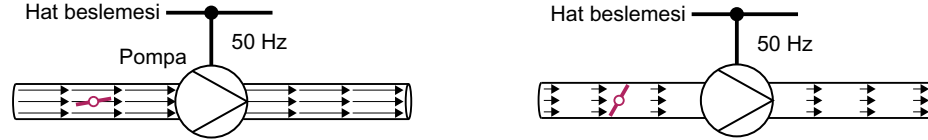
Resim 8-217 Bir 50 Hz hat beslemesine bağlanan pompa ve kelebek ile akış kontrolü
