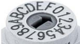
Figure 5-2 Roue codeuse (hexadécimale)
