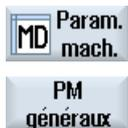
2. Actionnez la touche logicielle "Param. mach.", puis sélectionnez le groupe de paramètres machine souhaité (par ex. paramètres machine généraux).
