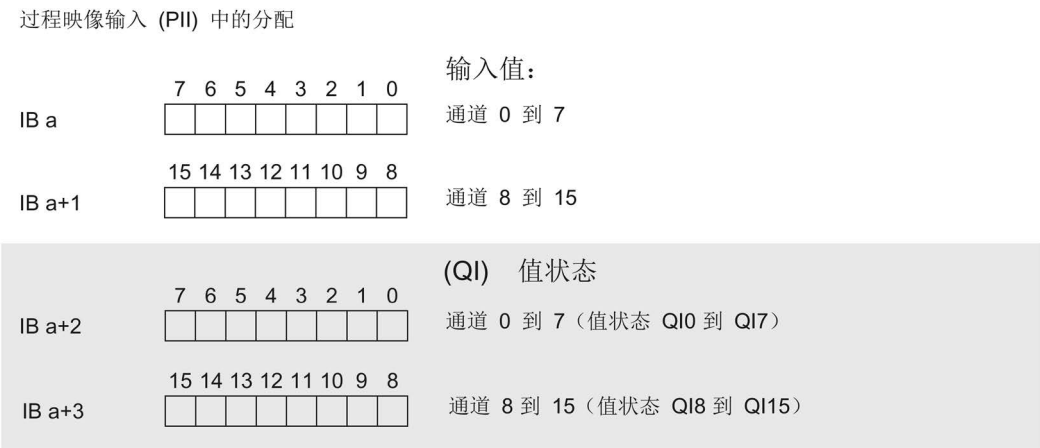
图 4-1 带有值状态的 DI 16x24VDC ST 的地址空间
