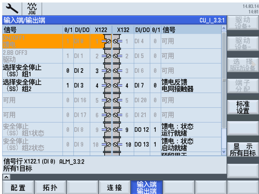
图 5-22 输入/输出的端子布局
