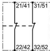
Hilfsschalterblock, seitlich, 2 Öffner
